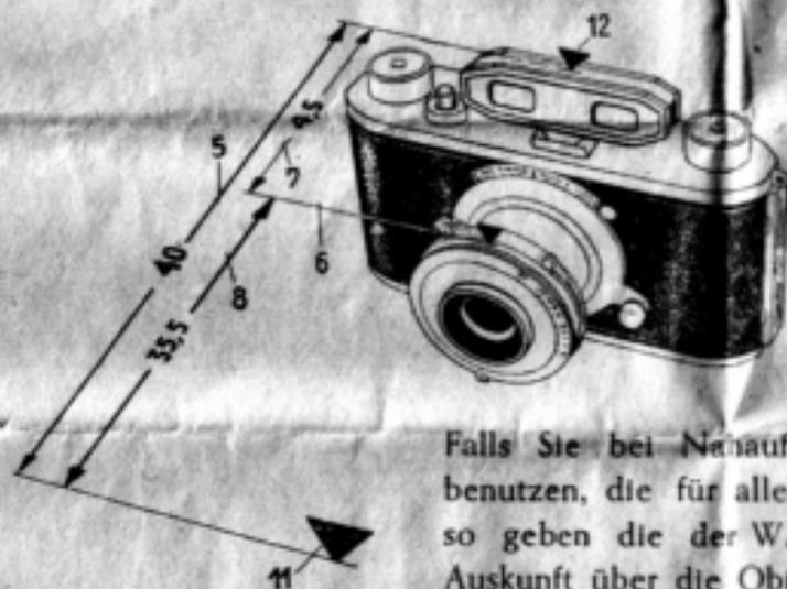
**Beispiel:** Die mit dem Entfernungsmesser gemessene Entfernung (5) beträgt 40 cm, die Strecke Blende — Mittellinie Entfernungsmesser (7) beträgt 4,5 cm, mithin beträgt die für die Nahaufnahme zu berücksichtigende Entfernung (8):
