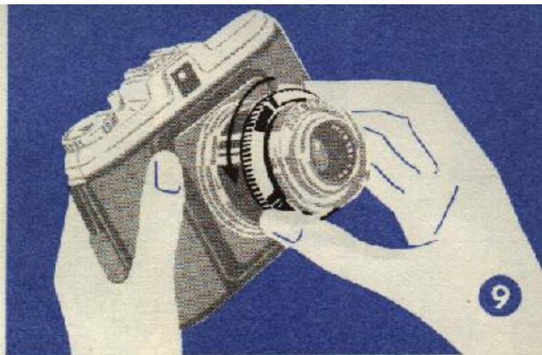
Zum Rücksetzen des Tubus faßt man den Rändelring, entriegelt ihn durch kurze Linksdrehung (siehe Abbildung mit Pfeil) und schiebt den Tubus bis zum Einschnappen in das Gehäuse.
