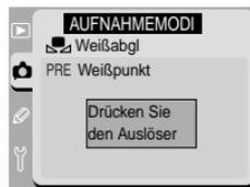
4 Achten Sie darauf, dass die gleiche Beleuchtung vorherrscht wie in der beabsichtigten Aufnahme, und richten Sie die Kamera so auf ein weißes oder neutralgraues Objekt, dass es das gesamte Sucherbildfeld ausfüllt. Drücken Sie den Auslöser bis zum zweiten Druckpunkt. Die Kamera löst daraufhin aus und speichert die gemessene Farbtemperatur als Messwert für den Weißabgleich – es wird jedoch keine Aufnahme auf der Speicher-karte gespeichert.
