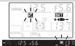
**4** Nehmen Sie eine Reihe von drei Bildern auf. Das erste Bild wird mit optimaler Belichtung aufgenommen, das zweite wird um die ausgewählte Belichtungsschrittweite unterbelichtet und das dritte um den gleichen Wert überbelichtet. Die Fortschrittsanzeige für Belichtungsreihen verringert sich nach jeder Aufnahme um ein Segment. Wiederholen Sie die Schritte 3 und 4, wenn Sie weitere Belichtungsreihen aufzeichnen möchten.
