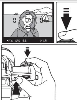
Bei aktiviertem Belichtungs-Messwertspeicher wird die Anzeige »EL« im Sucher eingeblendet.
