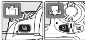
(Zwei-Tasten-Reset; beide Tasten sind mit einem grünen Punkt gekennzeichnet). Der Monitor schaltet sich vorübergehend aus, während die Einstellungen zurückgesetzt werden. Andere Einstellungen werden dadurch nicht auf die Standardwerte zurückgesetzt.
