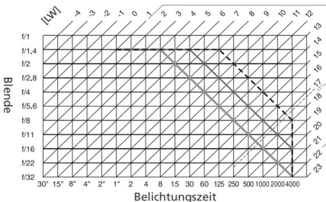
Die Grenzwerte des Belichtungsumfangs hängen von der eingestellten Empfindlichkeit ab (entsprechend ISO). Das Diagramm bezieht sich auf eine Empfindlichkeit von ISO 200. Bei Matrixmessung und Lichtwerten über  $17 \frac{1}{3}$  belichtet die Kamera wie Lichtwert  $17 \frac{1}{3}$ .
