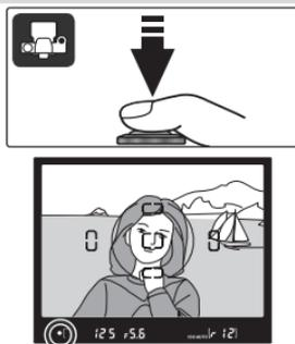
Wenn das Motiv sehr dunkel ist, schaltet die Kamera das AF-Hilfslicht zu, damit dem Autofokus ausreichend Licht für die Messung zur Verfügung steht. Möglicherweise wird auch das Blitzgerät aufgeklappt.
