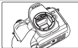
**5** Schalten Sie die Kamera aus. Der Spiegel schwenkt wieder in die Betriebsposition und der Verschlussvorhang schließt sich. Setzen Sie das Objektiv wieder an oder schützen Sie das Gehäuseinnere mit dem Gehäusedeckel. Anschließend können Sie die Verbindung zum Netzadapter trennen.
