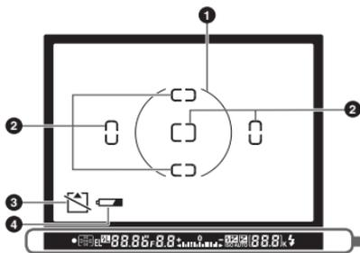
Wenn der Akku vollständig entladen ist, werden die Anzeigen im Sucher schwächer oder verschwinden ganz. Sobald ein vollständig aufgeladener Akku eingesetzt wird, erscheinen die Sucheranzeigen wieder.
