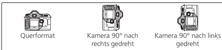
\* Bei Serienaufnahmen (21) gilt die für die erste Aufnahme aufgezeichnete Orientierung für alle Bilder derselben Belichtungsreihe, auch wenn die Kamera zwischendurch gedreht wird.
