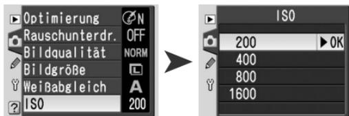
Mit langen Belichtungszeiten aufgenommene Fotos sind häufig verwackelt. Durch Auswahl einer höheren Empfindlichkeit (standardmäßig entspricht diese ISO 200) kann mit kürzeren Belichtungszeiten das gleiche Belichtungsergebnis erzielt und ein Verwackeln verhindert werden. Die Empfindlichkeit kann auf Werte zwischen ISO 200 und ISO 1600 eingestellt werden, die Schrittweite beträgt 1 LW.
