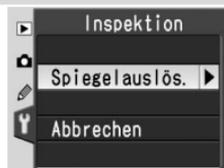
**3** Drücken Sie den Auslöser bis zum zweiten Druckpunkt. Daraufhin schwenkt der Spiegel nach oben in die Wartungsposition. Der Verschlussvorhang öffnet sich und gibt den Blick auf den Bildsensor mit dem Tiefpassfilter frei. Währenddessen blinkt eine gestrichelte Linie auf dem Display.
