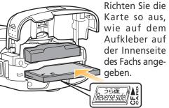
Speicherkarte mit der Anschlussleiste nach innen bis zum Anschlag einstecken. (Wie in der Abbildung gezeigt, muss die Oberseite der Karte zur Rückseite der Kamera zeigen, andernfalls können Kar te oder Kamera beschädigt werden.)
