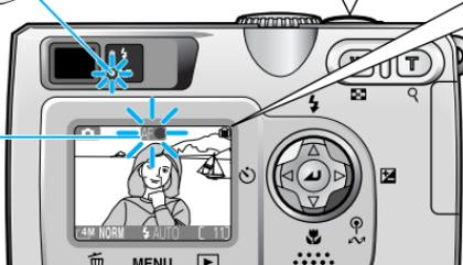
Die Kamera wählt beim Fokussieren unter den fünf AF-Messfeldern automatisch das Messfeld mit dem Objekt, das der Kamera am nächsten ist (Standardvorgabe bei Automatik). Die Messfelder erscheinen, wenn der Auslöser bis zum ersten Druckpunkt betätigt wird. Das gewählte AF-Messfeld wird grün markiert, sobald das Motiv scharf gestellt ist.
