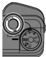
Mit dem Ein/Aus-Schalter wird die Kamera ein- und ausgeschaltet.
