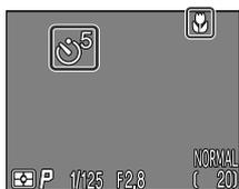
Die Selbstauslöser-anzeige auf dem Monitor zählt die verbleibenden Sekunden bis zum Auslösezeitpunkt rückwärts (Countdown).
