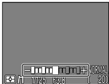
Der Monitor zeigt die Über- oder Unterbelichtung auf einer Skala von -2 LW bis +2 LW in Stufen von 1/3 LW an.
