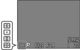
Die aktuell eingestellte Belichtungsmessmethode wird durch ein entsprechendes Symbol auf dem Monitor kenntlich gemacht.
