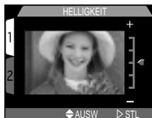
Das Erhöhen der Monitorhelligkeit wirkt sich auch auf die Wiedergabe der Aufnahmen auf einem Fernsehmonitor aus (dazu kann die Kamera an ein Fernsehgerät oder einen Videorekorder angeschlossen werden). Möglicherweise erscheinen die Bilder dann auf dem Fernsehmonitor etwas zu hell oder zu blass.
