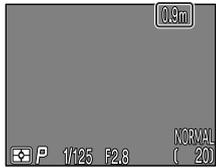
Welche Entfernungen zur Auswahl stehen, hängt von der aktuellen Autofokus-Betriebsart ab (S. 92). Entfernungen im Makrobereich zwischen 0,03 und 0,3 m sind nur bei den Einstellungen (Makro) und (Makro mit Selbstauslöser) möglich.
