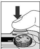
Auslöser bis zum zweiten Druckpunkt drücken
