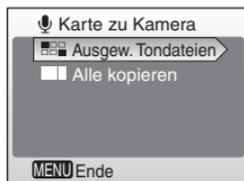
**4** Drücken Sie den Multifunktionswähler oben oder unten (▲ oder ▼), um eine Tonaufnahme auszuwählen, und drücken Sie anschließend die Taste ►.
