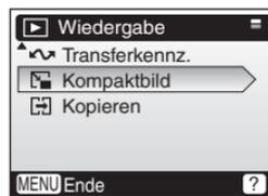
**3** Drücken Sie den Multifunktionswähler oben oder unten (▲ oder ▼), um die gewünschte Kompaktbildgröße auszuwählen, und drücken Sie anschließend die Taste **OK**.
