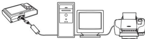
Verwenden Sie die mitgelieferte PictureProject-Software, um Bilder auf einen Computer zu kopieren und sie dann zu organisieren, durchzusuchen, zu bearbeiten und abzuspeichern. Sie können außerdem Bilder mit einem an den Computer angeschlossenen Drucker ausdrucken. Schließen Sie die Kamera mithilfe des im Lieferumfang enthaltenen USB-Kabels an den Computer an.
