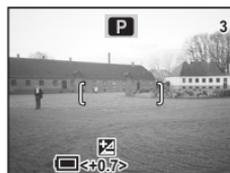
Die LW-Korrektur-Einstellung wird am LCD-Monitor angezeigt.
