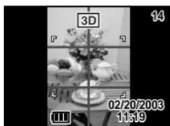
Das Bild wird in der linken Bildschirmhälfte des LCD-Monitors dargestellt. Die rechte Bildschirmhälfte dient zur Aufnahme des zweiten Bildes.
