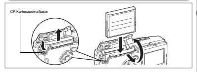
Die gemachten Aufnahmen werden auf der CF-Karte (CompactFlash) gespeichert. Vergewissern Sie sich, dass die Kamera ausgeschaltet ist. bevor eine CF-Karte (Marktprodukt) einlegen oder entfernen.
