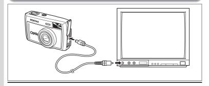
Mit dem Videokabel können Sie Bilder aufzeichnen und wiedergeben, indem Sie ein Fernsehgerät oder ein anderes mit einem Videoeingang ausgerüstetes Gerät als Ihren Monitor verwenden. Achten Sie darauf, dass sowohl das Fernsehgerät wie auch die Kamera ausgeschaltet sind, bevor Sie das Kabel anschließen.
