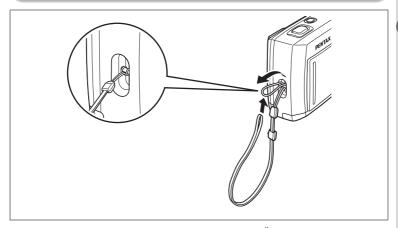
Stecken Sie das dünne Ende des Riemens durch die Öse an der Kamera und befestigen Sie es wie abgebildet.
