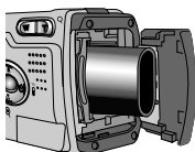
【 Batterie vom Typ CR-V3 einlegen 】
