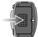
3. Um den Batteriefachdeckel zu schließen, schieben Sie ihn, bis er einrastet.
