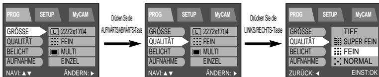
4. Bewegen Sie den Cursor mit der RECHTS-Taste zum Untermenü. Mit der LINKS-Taste setzen Sie den Cursor in das Hauptmenü.
