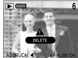
4. Um den Löschvorgang abzubrechen, drücken Sie die LINKS-Taste. Drücken Sie die OK-Taste. Eine Meldung ähnlich der hier dargestellten wird auf dem LCD-Monitor angezeigt. Markieren Sie mit der AUFWÄRTS/ABWÄRTS-Taste [DELETE] oder [CANCEL] und drücken Sie die OK-Taste.
