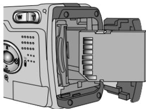
3. Zum Schließen schieben Sie den Batteriefachdeckel, bis er hörbar einrastet. Wenn sich die Speicherkarte nicht problemlos einsetzen lässt, versuchen Sie es nicht mit Gewalt. Überprüfen Sie die Einschubrichtung und setzen Sie sie anschließend richtig herum ein. Setzen Sie die Speicherkarte nicht falsch herum ein. Sonst kann der Speicherkartensteckplatz beschädigt werden.
