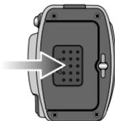
3. Um den Batteriefachdeckel zu schließen, schieben Sie ihn, bis er einrastet.
