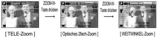
**Digitales WEITWINKEL-Zoom** : Ist der Digitalzoom in Betrieb, wird durch Drücken der Zoomtaste W der digitale Zoom schrittweise verringert.
