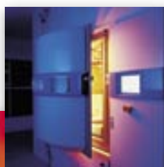
In hochmodernen Vakuum-Vergütungsanlagen erfolgt die reflexmindernde Beschichtung
