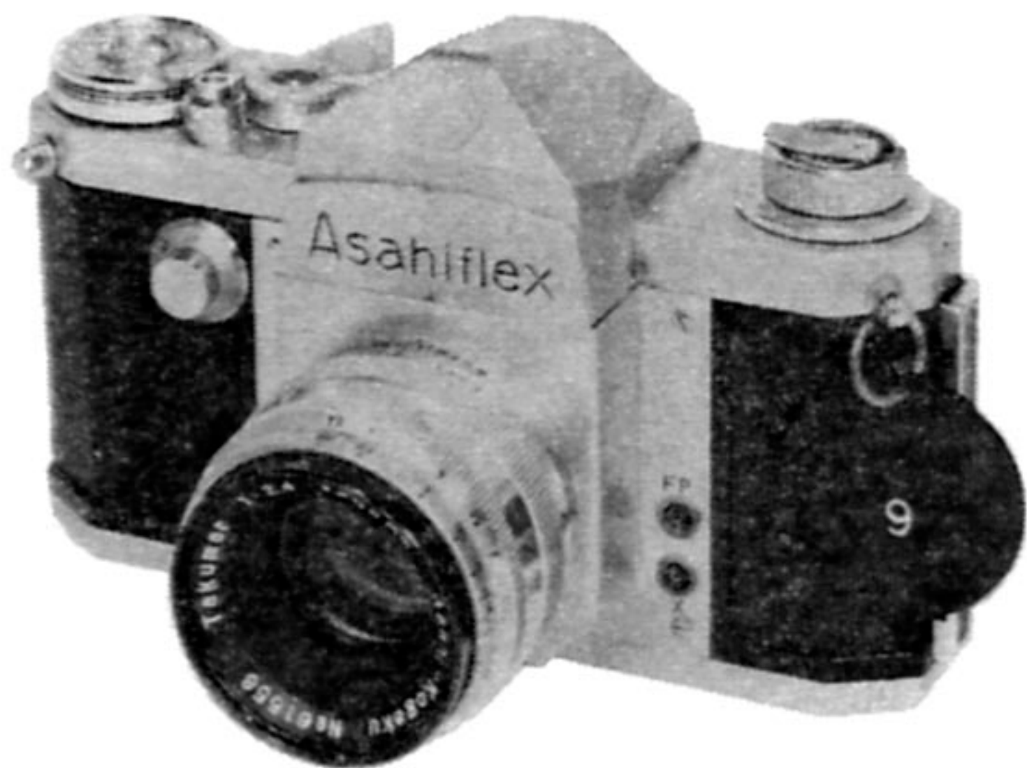
ペンタプリズム付の試作カメラ
