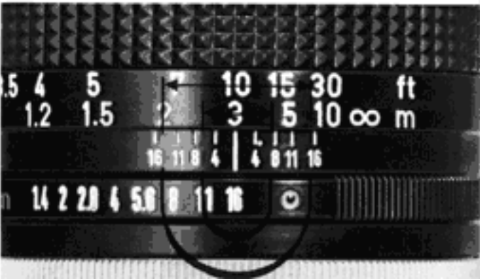
Objectif 50 mm F 16 Profondeur de champ 1,9-7,6 m Pour une mise au point sur 3 m
