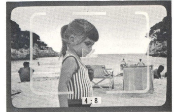
Zum Bild oben: Auf's Bild kommt, was Sie innerhalb des Leuchtrahmens sehen. Die Blende ist auf 5,6 eingestellt (Punkt zwischen 4 und 8). In der Suchermitte das Meßfeld des Entfernungsmessers.
