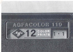
5 Filtransport ist nun gesperrt. Kamera kann bis zur nächsten Auslösung beliebig oft zusammengeschoben werden.
