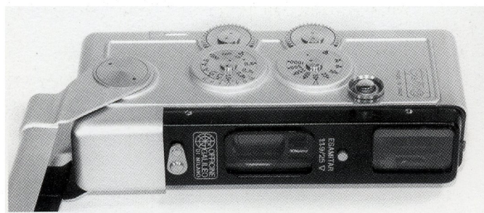
Le GaMi 16 ouvert, vue de face: levier du filtre jaune, sigle fabricant, fenêtre de l'objectif et du télémètre, fenêtre du viseur, une glissière sur la fenêtre d'objectif et un plot entre les 2 fenêtres servent au maintien des accessoires optiques.
