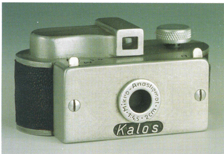
Vorderansicht der „bildschönen“ Kalos mit dem markanten Schriftzug unter dem Objektiv, gut erkennbar sind auch die beiden Auslöser links und rechts oben für Moment- und Langzeitaufnahmen sowie der optische Sucher.
