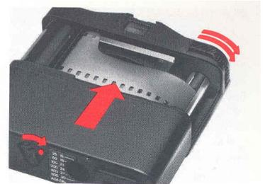
Abwechselnd transportieren und auslösen, bis die ersten Löcher der zweiten, oberen Perforation des Filmes sichtbar sind und der Filmanfang glatt auf der Filmführung der Camera aufliegt.
