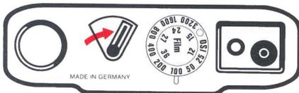
Codage DX: si on utilise des films avec code DX, l'appareil règle la sensibilité du film automatiquement entre ISO 25 et ISO 3200. Si le film n'est pas codé DX, l'appareil se règle automatiquement sur ISO 25.
