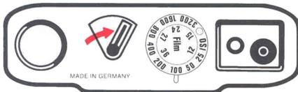
DX-Codierung: Beim Einlegen des Filmes wird die Filmempfindlichkeit zwischen ISO 25 und ISO 3200 automatisch abgetastet. Bei nichtcodierten Filmen stellt sich die Kamera automatisch auf ISO 25 ein.
