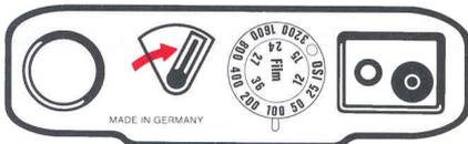
DX-Codierung: Beim Einlegen des Filmes wird die Filmempfindlichkeit zwischen ISO 25 und ISO 3200 automatisch abgetastet. Bei nichtcodierten Filmen stellt sich die Kamera automatisch auf ISO 25 ein.
