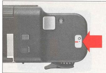
Prüfen, ob der Bildzähler (1) auf der Einlegstellung (schwarzer Punkt vor der Null) steht. Wenn nicht, Taste (9) drücken, Frontklappe (17) öffnen, Filmtransport bis zum Stop betätigen, Auslöser (3) drücken.
