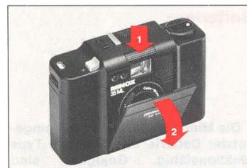
Beim Schließen der Frontklappe wird das Objektiv (16) eingefahren, der Sucherausblick (10) verdeckt, der Auslöser (3) gesperrt und die gesamte Elektronik ausgeschaltet.
