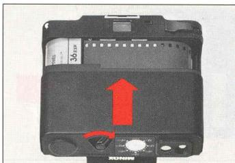
Camera-Rückwand aufschieben und durch Umschwenken des Verriegelungshebels (25) verriegeln (roter Punkt wird durch den Hebel verdeckt).
