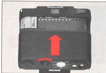
Camera-Rückwand aufschieben und durch Umschwenken des Verriegelungshebels (25) verriegeln (roter Punkt wird durch den Hebel verdeckt).
