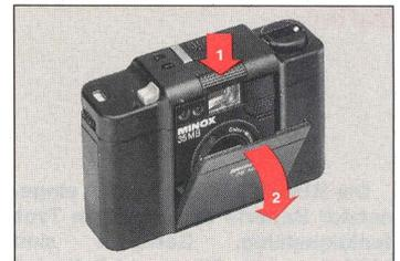
Beim Schließen der Frontklappe wird das Objektiv (16) eingefahren, der Sucherausblick (10) verdeckt, der Auslöser (3) gesperrt und die gesamte Elektronik ausgeschaltet.
