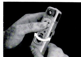
Daumen auf die Skala, Zeigefinger auf die Unterseite, mit der anderen Hand Camera drehen.
