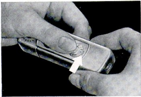
So wird die Entfernung eingestellt. Der Pfeil zeigt auf die Tiefenschärfenklammer
