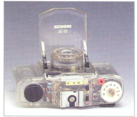
Die Klappe zum geschützten Versenken des Objektivs in das Gehäuse hat die Minox 35 weltberühmt gemacht und neben anderen Features für hohe Verkaufszahlen gesorgt.
