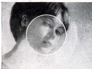
Mikroprismenraster flimmert = unscharf
