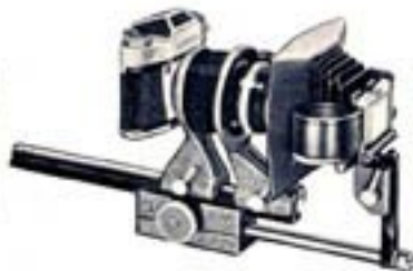
Die EXA 500 am Balgennaheinstellgerät mit Diakopiervorsatz
