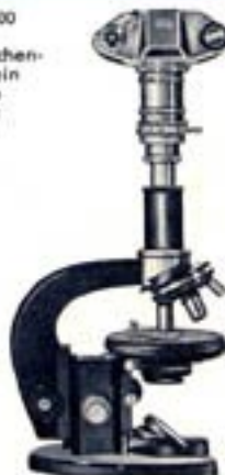
Die EXA 500 am Balgennaheinstellgerät mit Diakopiervorsatz
