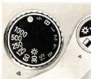
Belichtungszeiten von 1s bis 1/1000s auf einem Einstellknopf
