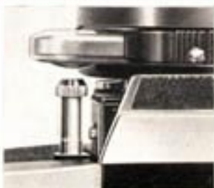
Blendenautomatik früherer Objektive am Links auslöser zu betätigen
