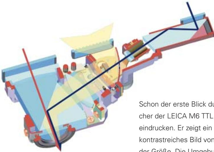
*Der Meßsucher der LEICA M6 TTL besteht aus über 100 Einzelteilen. Er ist in der Fertigung weitaus aufwendiger als der Sucher einer Spiegelreflexkamera.*
