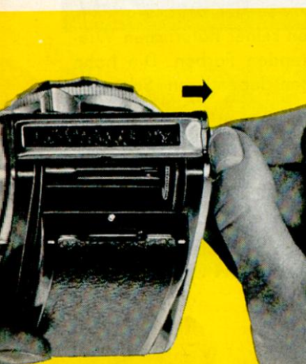
Jetzt mit Fingernagel unter Kurbelarm fassen, nach außen umlegen und Kurbel kräftig bis Anschlag herausziehen. Filmpatrone mit Bohrung zur Rückspulkurbel einlegen. Deren Mitnehmergabel muß in Bohrung der Filmpatrone fassen,
