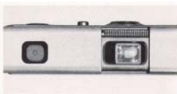
Kreis im Objektivfenster: Die Minox ist schußbereit.
