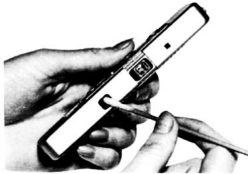
Objektivfenster mit Wattestäbchen reinigen – oder mit sauberem Lappchen (um ein Streichholz wickeln).
