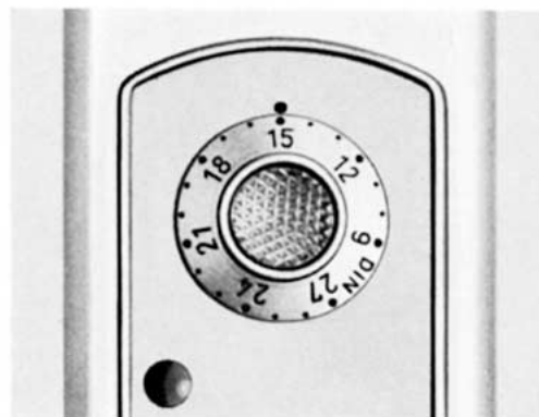
Filmempfindlichkeitsskala, eingestellt auf 15 DIN
