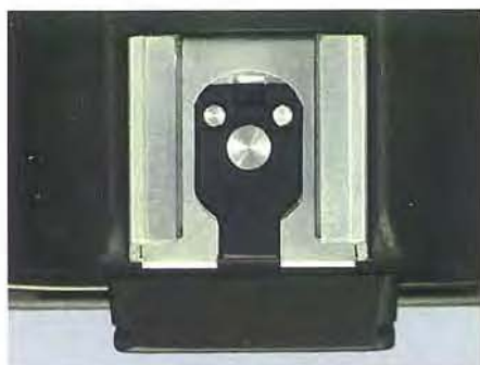
Steckschuh mit TEF-, CC- und Mittenkontakt für TTL-Blitztechnik
