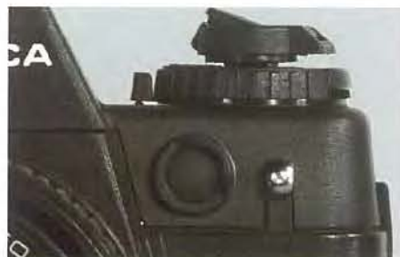
Oben: Einstellzeiger für Belichtungskorrektur auf Minuswert Unten: Speicher- und Batterieprüftaste (Doppel- funktion)
