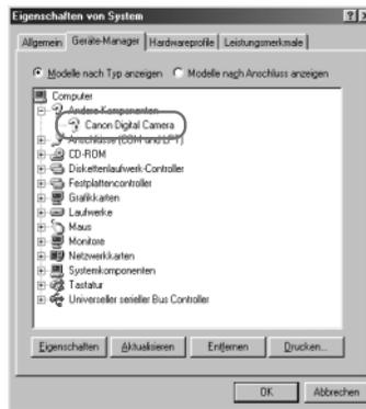
→ Wenn [EOS D60] oder [Canon Digital Camera] unter [Andere Geräte] oder [Unbekannte Geräte] angezeigt wird, wurde der Treiber nicht ordnungsgemäß installiert. Führen Sie die folgenden Schritte aus, um den Treiber erneut zu installieren.
