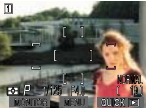
Autofokus mit fünf Messfeldern
