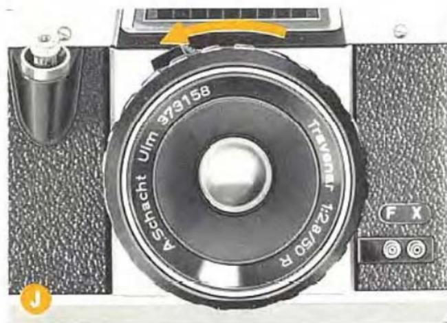
Rückschwenksspiegel am Rahmen anheben und den rot markierten Knopf bis zum Anschlag nach rechts schieben (Abb. K). Den Rückschwenkspiegel wieder loslassen, er springt in seine Ausgangsstellung zurück. (Es ist möglich, daß der Rückschwenkspiegel bei gespanntem Verschuß angehoben wird und dann in waagerechter Stellung stehen bleibt. Bitte den Auslöser drücken, der Rückschwenkspiegel springt zurück).
