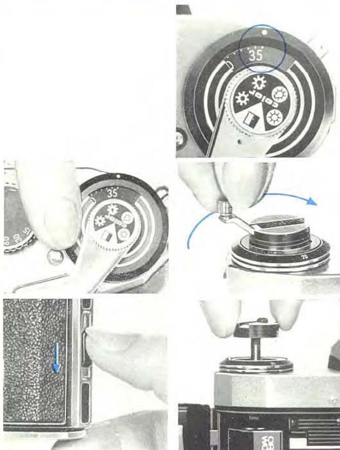
Objektiv am Objektivkörper fassen und nach links herausdrehen, Wechselobjektiv durch Rechtsdrehen einschrauben.
