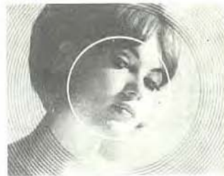
Mikroprismenraster flimmerfrei = scharf
