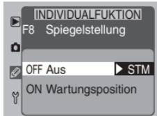
**5** Markieren Sie die Option »**Wartungsposition**«, und drücken Sie den Multifunktionswähler rechts. Daraufhin schwenkt der Spiegel nach oben in die Wartungsposition. Der Verschlussvorhang öffnet sich und gibt den Blick auf die CCD mit dem Low-Pass-Filter frei.
