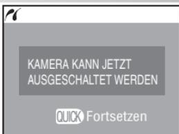
Nach dem Drucken erscheint die links abgebildete Meldung auf dem Monitor. Schalten Sie die Kamera aus und ziehen Sie das USB-Kabel ab. Oder drücken Sie die Taste
