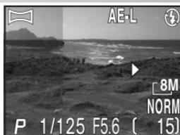
Belichten Sie die erste Aufnahme. Etwa ein Drittel der ersten Aufnahme wird als halbttransparentes Bild über dem Livebild auf dem Monitor eingeblendet. Wenn Sie die Kamera von links nach rechts schwenken, wird das rechte Drittel der vorherigen Aufnahme am linken Rand des Monitors eingeblendet. Die Anzeige »AE-L« wird weiß hervorgehoben, um darauf hinzuweisen, dass der Weißabgleich und die Belichtungseinstellungen der ersten Aufnahme für alle weiteren Aufnahmen der Serie fixiert wurden.
