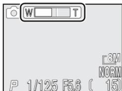
Die Zoomanzeige wird eingeblendet, wenn eine der beiden Zoomtasten gedrückt wird.
