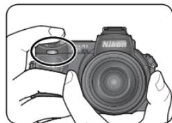
bzw. die Tonaufnahme nicht gestört wird. Halten Sie die Kamera so, dass auch die Lampe zur Reduzierung des Rote-Augen-Effekts nicht verdeckt wird.
