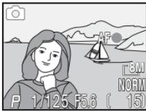
Die Messwerte für Fokus und Belichtung bleiben fixiert, solange der Auslöser in dieser Position gehalten wird.\*
