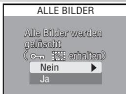
Es erscheint eine Sicherheitsabfrage. Drücken Sie den Multifunktionswähler oben oder unten, um eine Option zu markieren, und anschließend rechts, um sie auszuwählen.
