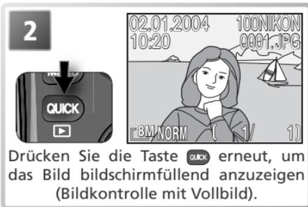
Drücken Sie den Multifunktionswähler oben bzw. links, um zu früher aufgenommenen Bildern zu blättern, oder unten bzw. rechts, um spätere Aufnahmen anzuzeigen. Sie können jederzeit zur Aufnahmebereitschaft zurückkehren, indem Sie den Auslöser bis zum ersten Druckpunkt drücken oder die Taste **QUICK** ein drittes Mal betätigen.
