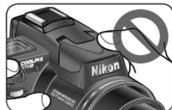
Versuchen Sie nicht, das integrierte Blitzgerät mit der Hand aufzuklappen. Andernfalls besteht die Gefahr, dass Sie das Gerät beschädigen. Wenn Sie das Blitzgerät wieder zuklappen wollen, drücken Sie es vorsichtig mit der Hand nach unten, bis es mit einem Klick einschnappt.
