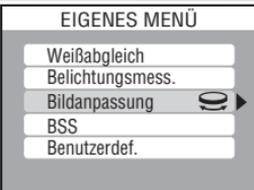
Der markierte Menüpunkt ersetzt den in Schritt 3 ausgewählten Menüpunkt. Wiederholen Sie die Schritte 3 bis 6, um weitere Menüpunkte zu ändern, oder drücken Sie die Taste
