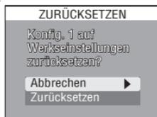
Mit der Option »Zurücksetzen« werden folgende Einstellungen der aktuellen Benutzerkonfiguration (»Konfig. 1« oder »Konfig. 2«) auf die Werkseinstellungen zurückgesetzt. Die Einstellungen der anderen Benutzerkonfiguration werden nicht geändert.
