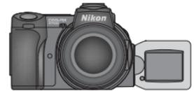
Wenn der Monitor in dieselbe Richtung wie das Objektiv zeigt, können Sie ihn auch nach hinten umklappen und in der Rückwand des Kameragehäuses einschnappen lassen (sinnvoll bei der Wiedergabe der gespeicherten Bilder oder bei Aufnahmen, bei denen die Aufnahmerichtung der Kamera mit Ihrer Blickrichtung übereinstimmt).
