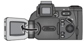
Wenn der Monitor aufgeklappt ist, lässt er sich um 180° nach vorn und um 90° nach hinten drehen.
