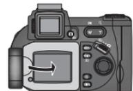
Wenn die Kamera nicht benutzt wird, sollten Sie den Monitor so in der Gehäuserückwand versenken, dass die empfindliche Seite nach innen zeigt und vor Staub und Fingerabdrücken geschützt ist.
