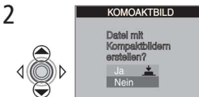
Markieren Sie die Option »**Ja**«. (Um das Menü zu verlassen, ohne ein Kompaktbild zu erstellen, markieren Sie »**Nein**« und drücken den Multifunktionswähler rechts.)
