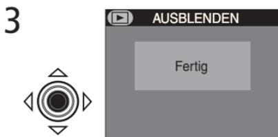
Drücken Sie den Multifunktionswähler in der Mitte, um die Kennzeichnung der Bilder zu bestätigen und wirksam werden zu lassen. Wenn Sie den Index der Funktion »**Ausblenden**« verlassen möchten, ohne den Sichtbarkeitsstatus der Bilder zu ändern, drücken Sie die MENU-Taste.
