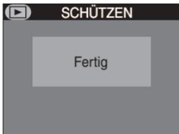
Drücken Sie den Multifunktionswähler in der Mitte, um die Kennzeichnung der Bilder zu bestätigen und wirksam werden zu lassen. Wenn Sie das Menü verlassen möchten, ohne den Schutzstatus der Bilder zu ändern, drücken Sie die MENU-Taste.
