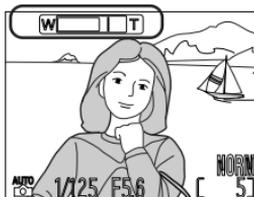
Wenn eine der beiden Zoomtasten gedrückt wird, wird die aktuelle Zoomposition auf dem Monitor angezeigt.
