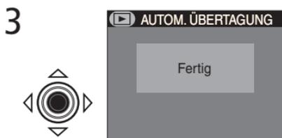
Drücken Sie den Multifunktionswähler in der Mitte, um die Kennzeichnung der Bilder zu bestätigen und wirksam werden zu lassen. Wenn Sie den Index der Funktion »**Autom. Übertragung**« verlassen möchten, ohne den Transferstatus der Bilder zu ändern, drücken Sie die MENU-Taste.
