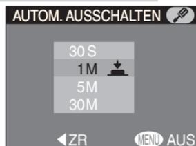
Bei Netzbetrieb (Netzadapter als Sonderzubehör erhältlich), schaltet die Kamera – unabhängig von den Einstellungen im Menü »**Autom. Ausschalten**« – automatisch nach 30 Minuten aus, wenn in dieser Zeit keine Eingabe erfolgt.
