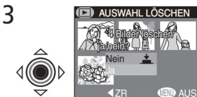
Drücken Sie den Multifunktionswähler in der Mitte. Es erscheint eine Sicherheitsabfrage. Drücken Sie den Multifunktionswähler oben oder unten, um die gewünschte Option zu markieren und anschließend in der Mitte, um die Auswahl wirksam werden zu lassen.
