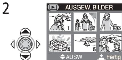
Drücken Sie den Multifunktionswähler oben oder unten, um das markierte Bild mit dem Autotransfersymbol zu kennzeichnen. Wiederholen Sie die Schritte 1 und 2 für alle weiteren Bilder, die gekennzeichnet werden sollen. Um das Autotransfersymbol wieder zu entfernen, markieren Sie das Bild erneut und drücken den Multifunktionswähler oben oder unten.
