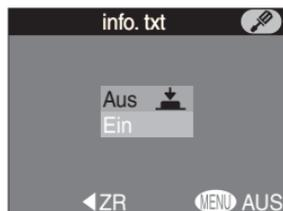
Die Textdatei befindet sich im selben Ordner wie die Bilddatei. Von einem Computer aus kann die Datei mit einem einfachen Textprogramm wie Notepad oder SimpleText geöffnet werden. Die Angaben zu den einzelnen Aufnahmen sind jeweils durch eine Leerzeile getrennt und in chronologischer Reihenfolge aufgelistet.
