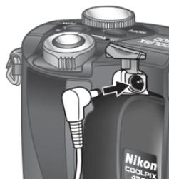
Anschluss des Netzadapters an die COOLPIX 4500
