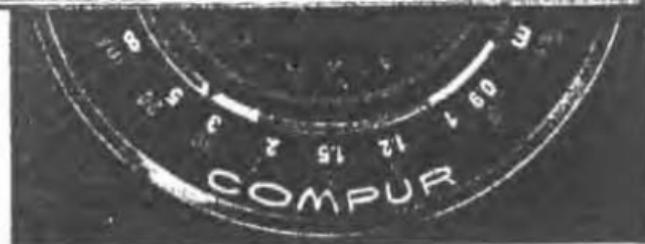
Genauere Entfernungangaben von 0,9 m bis  $\infty$  finden Sie auf dem unteren Teil des Einstellrings.
