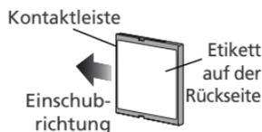
Das Speicherkartenfach ist mit einem geringen Neigungswinkel gegenüber der Kamerarückwand konstruiert. Halten Sie die Karte daher beim Einsetzen etwas schräg (siehe Abbildung).
