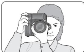
Das als Zubehör erhältliche Multifunktions-Batterieteil MB-D100 ist mit einem zweiten Auslöser für Hochformataufnahmen ausgestattet.
