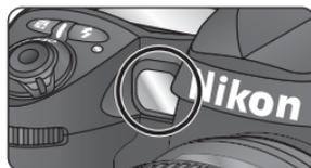
Der AF-Hilfsilluminator arbeitet nur korrekt, wenn die Objektivbrennweite zwischen 24 und 200 mm liegt und sich das Motiv innerhalb der Hilfslichtreichweite befindet. Bei den meisten Objektiven liegt die Hilfslichtreichweite zwischen 0,5 und 3 m. Mit den folgenden Objektiven kann der AF-Hilfsilluminator nicht bei Entfernungen von weniger als 1 m verwendet werden:
