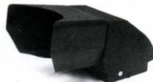
Reflexsucher-Lichtschacht (455) Erlaubt leichtes und bequemes Einstellen bei Benutzung der Kamera in der Vertikalen. Das Sucherbild kann in Augenhöhe betrachtet werden. Seitenlicht wird durch den der Kopfform angepaßten Lichtschacht abgehalten.
