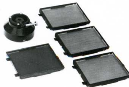
Rasterzubehör Zur Herstellung sofort fertiger aufgerasterter Positive von Halbtonvorlagen. Das Zubehör besteht aus einer einstellbaren Zusatz-Rasterblende, feststellbarem Drahtauslöser, Belichtungstabelle sowie vier Glasgravurrastern.
