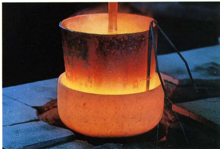
Höchste Reinheit ist beim Schmelzen hochwertiger optischer Gläser oberstes Gebot. Dieser Schmelztiegel dürfte wohl einer der wertvollsten seiner Art sein. Er ist aus reinem Platin.
