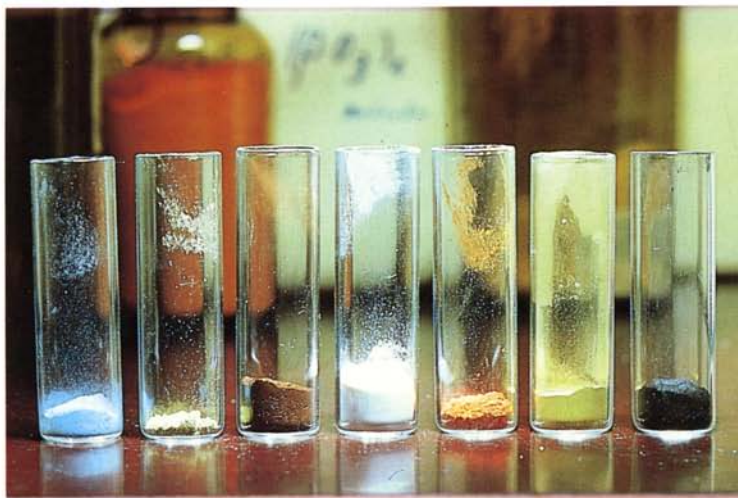
Im Leitz-Glasforschungslaboratorium werden unter Verwendung von seltenen Erden die Gläser erschmolzen, denen Leitz-Objektive ihre Leistung verdanken.
