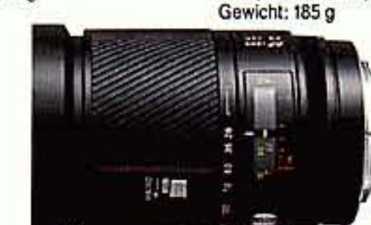
AF 4-4,5/28-135mm Konstruktion: 16 Linsen in 13 Gruppen Bildwinkel: 75° - 18° Nahgrenze (Macro): 1,5m (0,25m) Max. Abbildungsmaßstab: 1:4 (0,25 x) Kleinste Blende: 22 - 27 Filtergewinde: 72mm Ø Abmessungen: 75mm Ø x 109mm Gewicht: 750 g
