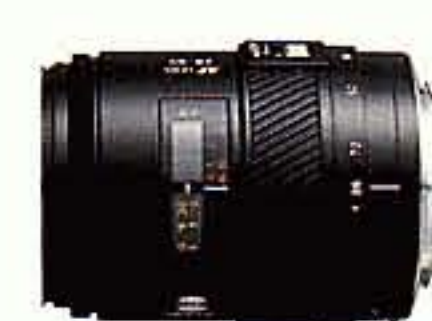
AF 3,5-4,5/28-85mm Konstruktion: 13 Linsen in 10 Gruppen Bildwinkel: 75° - 29° Nahgrenze (Macro): 0,8m (0,25m) Max. Abbildungsmaßstab: 1:4 (0,25 x) Kleinste Blende: 22 - 27 Filtergewinde: 55mm Ø Abmessungen: 68,5mm Ø x 85,5mm Gewicht: 490 g
