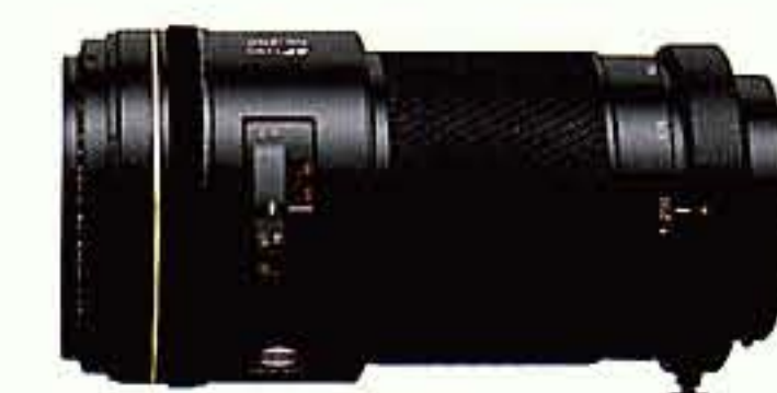
AF-Apo 2,8/80-200mm Konstruktion: 16 Linsen in 13 Gruppen Bildwinkel: 30° - 12° 30' Nahgrenze: 1,8m Kleinste Blende: 32 Filtergewinde: 72mm Ø Abmessungen: 87,5mm Ø x 166,5mm Gewicht: 1300 g
