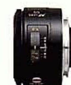
AF 1,4/50mm Konstruktion: 7 Linsen in 6 Gruppen Bildwinkel: 47° Nahgrenze: 0,45m Kleinste Blende: 22 Filtergewinde: 49mm Ø Abmessungen: 65,5mm Ø x 38,5mm Gewicht: 235 g
