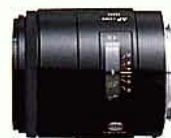
AF 2/100mm Konstruktion: 7 Linsen in 6 Gruppen Bildwinkel: 24° Nahgrenze: 1,0m Kleinste Blende: 32 Filtergewinde: 55mm Ø Abmessungen: 67mm Ø x 75,5mm Gewicht: 480 g
