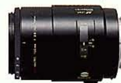
AF-Macro 2,8/100mm Konstruktion: 8 freistehende Linsen Bildwinkel: 24° Nahgrenze: 0,35m Max. Abbildungsmaßstab: 1:1 (1,0 x) Kleinste Blende: 32 Filtergewinde: 55mm Ø Abmessungen: 71mm Ø x 98,5mm Gewicht: 520 g
