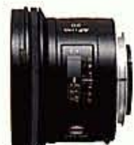
AF 2,8/20mm Konstruktion: 10 Linsen in 9 Gruppen Bildwinkel: 94° Nahgrenze: 0,25m Kleinste Blende: 22 Filtergewinde: 72mm Ø Abmessungen: 77,5mm Ø x 53,5mm Gewicht: 285 g
