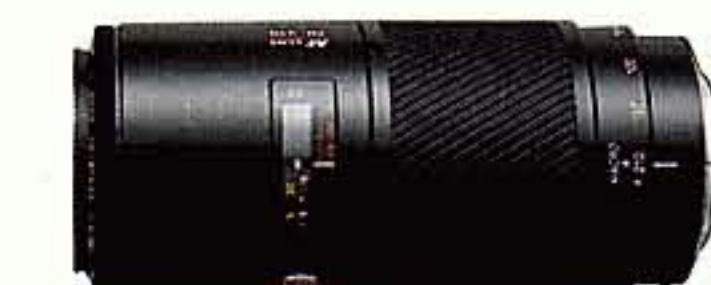
AF 4/70-210mm Konstruktion: 12 Linsen in 9 Gruppen Bildwinkel: 34° - 12° Nahgrenze (Macro): 1,1m (1,1m) Max. Abbildungsmaßstab: 1:3,9 (0,256 x) Kleinste Blende: 32 Filtergewinde: 55mm Ø Abmessungen: 72,5mm Ø x 152mm Gewicht: 695 g
