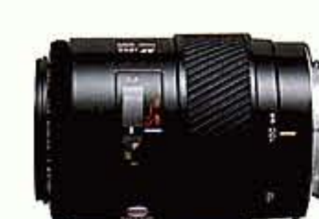
AF 4,5/100-200mm Konstruktion: 8 Linsen in 7 Gruppen Bildwinkel: 24° - 12° 30' Nahgrenze: 1,9m Kleinste Blende: 22 Filtergewinde: 49mm Ø Abmessungen: 69,5mm Ø x 94,5mm Gewicht: 375 g
