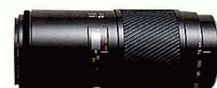
AF 4,5-5,6/75-300mm Konstruktion: 13 Linsen in 11 Gruppen Bildwinkel: 32° - 8° 10' Nahgrenze (Macro): 1,5m (1,5m) Größter Abbildungsmaßstab: 1:3,8 Kleinste Blende: 32 - 38 Filtergewinde: 55mm Ø Abmessungen: 72,5mm Ø x 163,5mm Gewicht: 865 g
